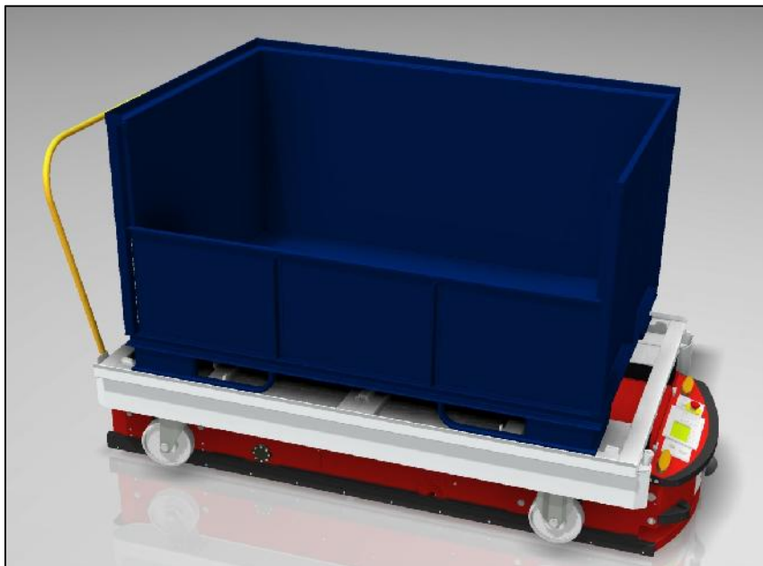
El AGV transporta los contenedores sobre una base con ruedas
